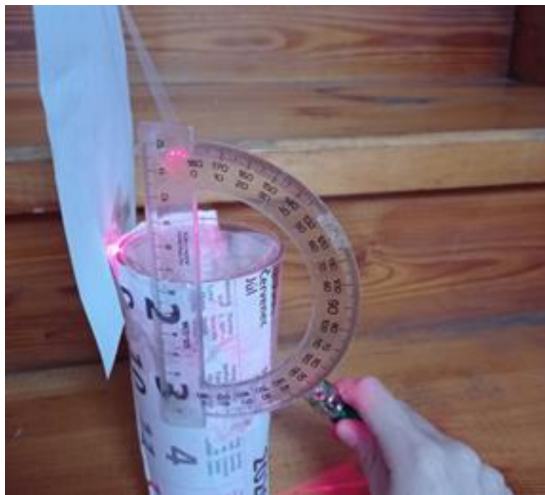
Obrázek 13: Aparatura na měření úhlu lomu
