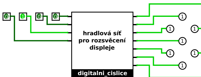
Obrázek 17: Ilustrační obrázek rozsvěcení sedmissegmentového displeje
